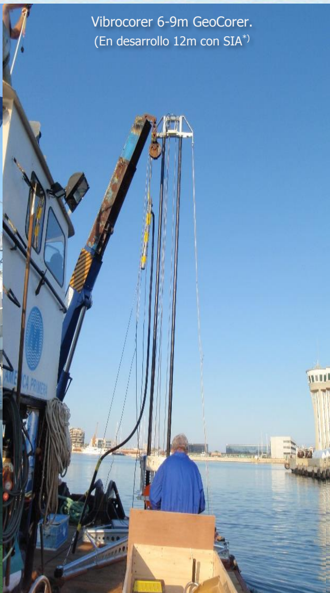
Vibrocorer 6m. B/O Ramón Margalef con SIA*
