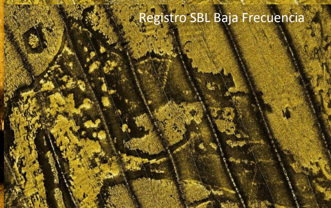
Emisario Submarino deformado por la dinámica de la zona
